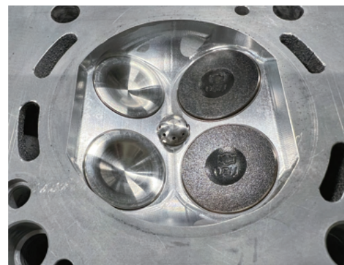
プレチャンバ装着(カットモデル)
